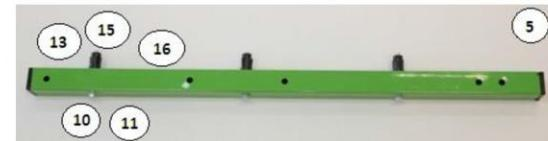
Дальнейшим шагом является сборка узла балки (5) и турника (6). На балку (5) со стороны где расположены три отверстия, вставляем болты М8x80 (11) с шайбами (10), с внутренней стороны на болт (11) одеваем вставку пластмассовую плоскую (13) и конус (15), накручиваем гайку M8 (16) на болт (11). **НЕ ЗАТЯГИВАЕМ БОЛТЫ М8x80 (11)!**
