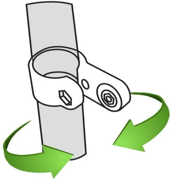
При установке, затягивая винт крепления хомута (рисунок 1), выбирайте усилие крутящего момента таким образом, чтобы установленного крыла оставалась возможность немного вращаться на подседельном штыре (рисунок 2). Это необходимо, чтобы предотвратить возможную поломку кронштейна крыла, при задевании крыла ногой, перевозке и падении велосипеда.
