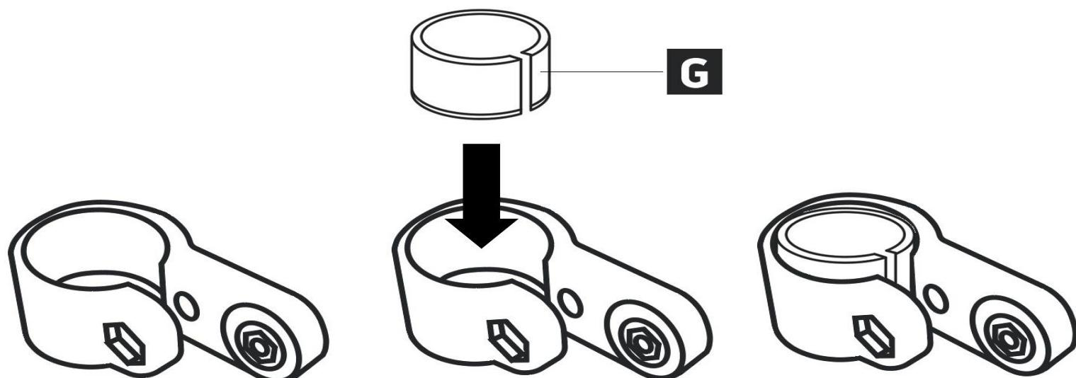
В комплект крыльев входят пластиковые проставки-переходники обозначенные буквой G. Проставки имеют различную толщину и предназначаются для компенсации диаметра подседельного штыря. На подседельные штыри диаметром 30,4мм хомут заднего крыла устанавливается без проставки, для штырей имеющих размеры 28,6мм и 27,2мм используется тонкая проставка, для штырей диаметром 25,4мм используется утолщенная проставка.
