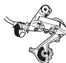
Рис. 19: Регулировка заднего переключателя, регулировка натяжения тросика (вид на переключатель сбоку)
